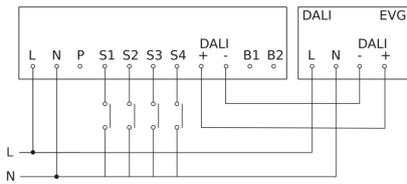
Schéma du circuit principal avec ballast électronique ARRÊT
