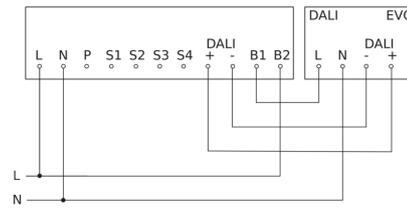
Schéma du circuit principal avec lampe commutée
